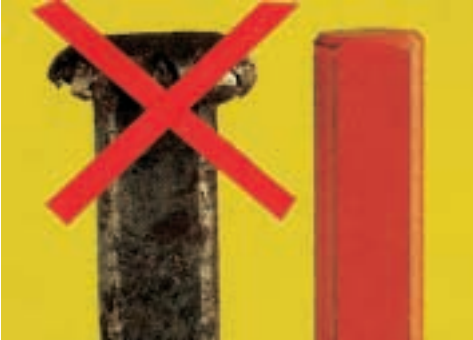
Meißelkopf – rechts fachgerecht angeschliffenes Schlagende
