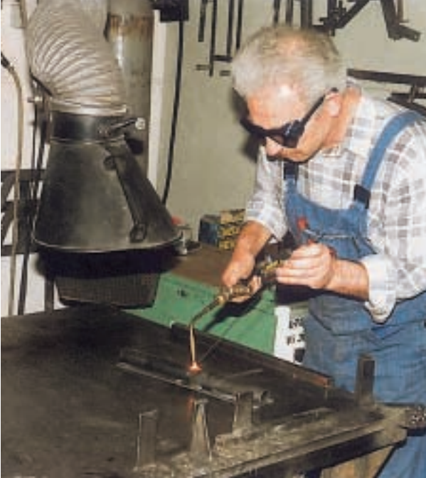
Absaugung der Schweißgase an der Entstehungsstelle (Quelle: BG der Feinmechanik und Elektrotechnik)
